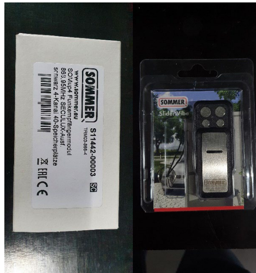
Abbildung 5 - Funkfernbedienung: Empfänger (links) + Sender (rechts)
