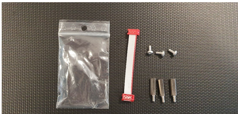
Figure 9 - Kit de montage livré avec la carte relais
